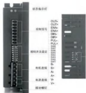
**脉冲及方向信号：**该驱动器有2 个高速输入口PUL 和DIR，光电隔离，可以接受5-24VDC 单端或差分信号，最高电压可达28V，信号下降沿有效。信号输入口有高速数字滤波器，滤波频率为2MHz。脉冲信号为下降沿有效。电机运转方向取决于DIR 电平信号，当DIR 悬空或为低电平时，电机顺时针运转。DIR 信号为高电平时，电机逆时针运转。
